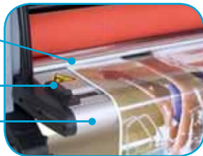
Bobinado, las impresiones pueden ser fácilmente bobinadas en el eje rebobinador.
